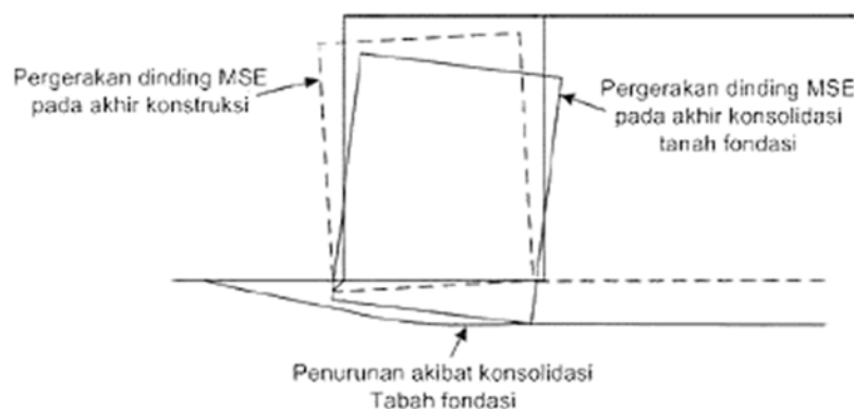
Gambar 58 – Pergerakan dinding MSE akibat penurunan konsolidasi tanah fondasi (GEO Hongkong, 2002)
