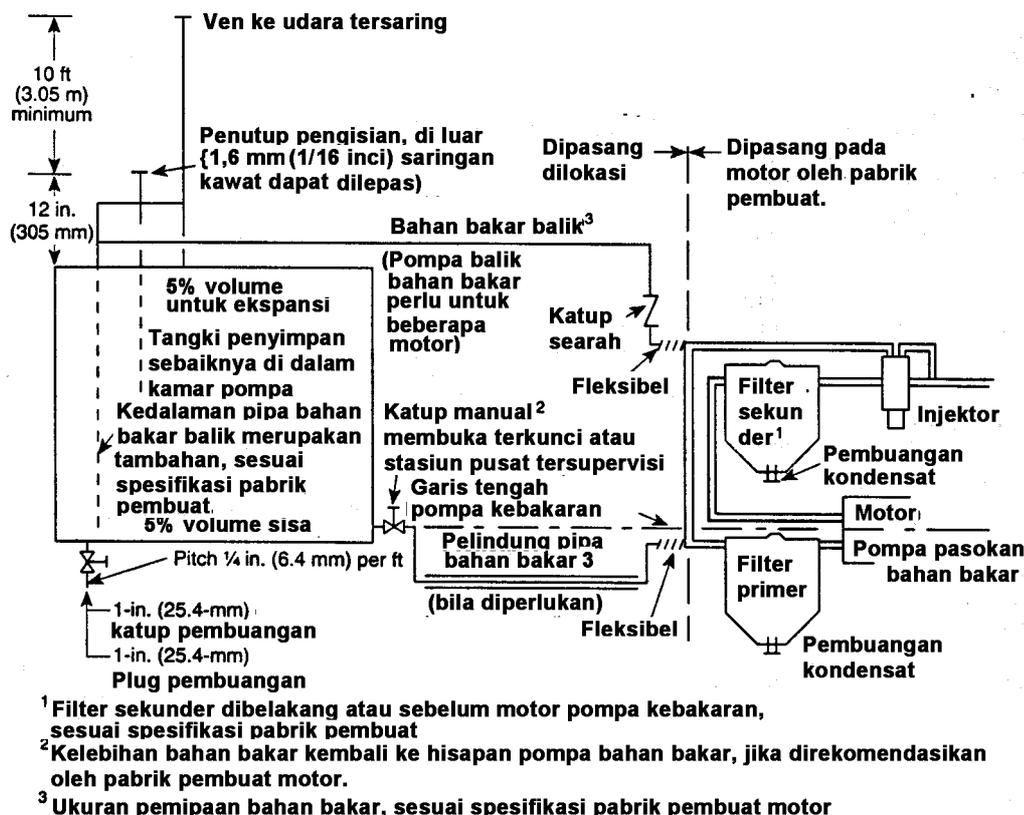
Gambar A.8.4.6 Sistem bahan bakar untuk motor diesel penggerak pompa kebakaran
